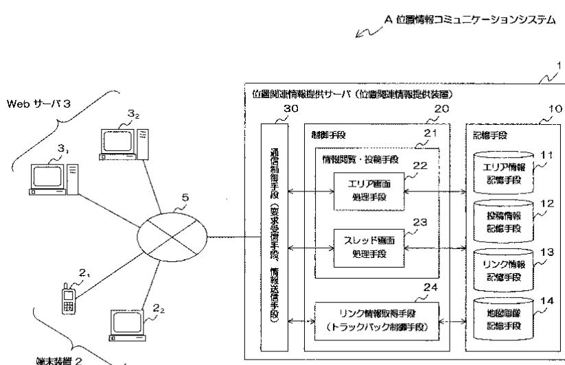
複数の端末装置(左図 2)から送信される投稿情報と、複数のWeb サーバ(同 3)から送信されるリンク情報とを、地理上の特定の位置を示す位置情報に関連付け、要求のあった端末装置に提供する位置関連情報提供装置(同 1)であって、投稿情報やリンク情報等の記憶手段(同 10)と、情報投稿手段、アドレス生成手段、リンク情報取得手段、情報閲覧手段等から成る制御手段(同 20)等とを備える構成となっている。
