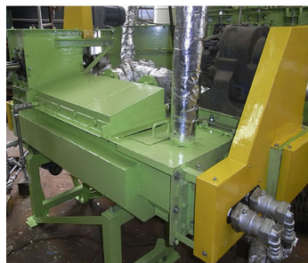
木材から汚泥まで乾燥できるスクリー式乾燥機
