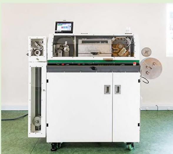
自社の非加熱圧縮ペレット再生機は、全く熱をかけずに丸みを帯びた循環ペレットを作成することができる。「インラインの原料再生に好適」「原材料費削減による収益アップ」「脱炭素社会に貢献」を実現する、自社独自の製品である。
