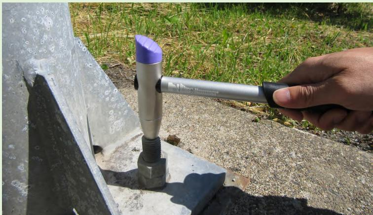
同社は総合建設会社であり、本業は土木工事受注業であるが、今回支援の対象としたのは、非破壊検査装置の開発製造販売業にて取り扱うボルトテスター（ボルト・ナット非破壊検査装置）である。
