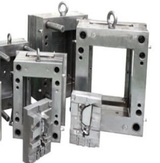
通常、金型は製品ごとに作製するため、作製コストがかさみます。当社のカセット金型はベース部分を共通化し、製品の金型（カセット金型）のみを交換するので、「通常の金型」に比べ30%前後はコスト削減できます。
