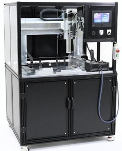
タングレスインサート全自動挿入装置
