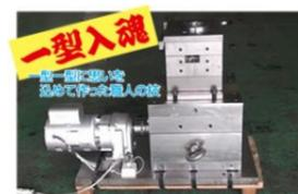
今回開発した「多段式射出成形技術」により、新たな成形機の導入なしに既存設備で量産化へのコストダウン提案ができます。2017年初受注、初納入し、2018年に超モノづくり部品大賞の機械・ロボット部品賞を受賞。2020年には更に改良を加えランナーレス多段射出成型金型を開発し、2022年には超モノづくり部品大賞・環境エネルギー関連賞受賞しました。
