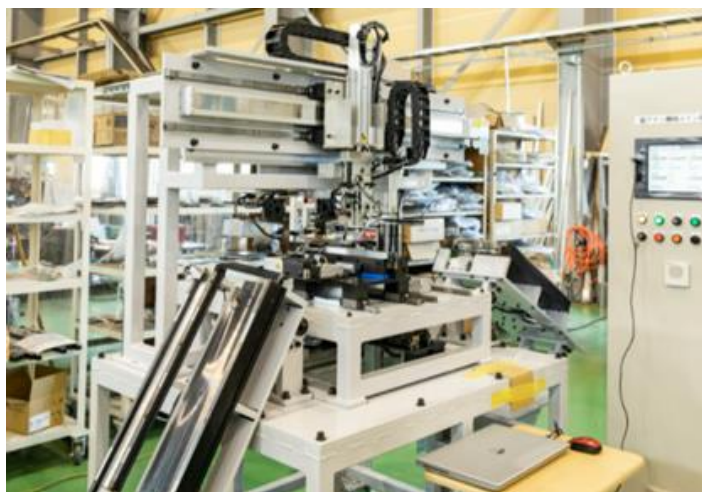
▲ダイワメカニクスはすべてがオーダーメイド。写真は鋸の歯の歯振（アサリ）を自動で制作するオーダーメイドの工作機械
