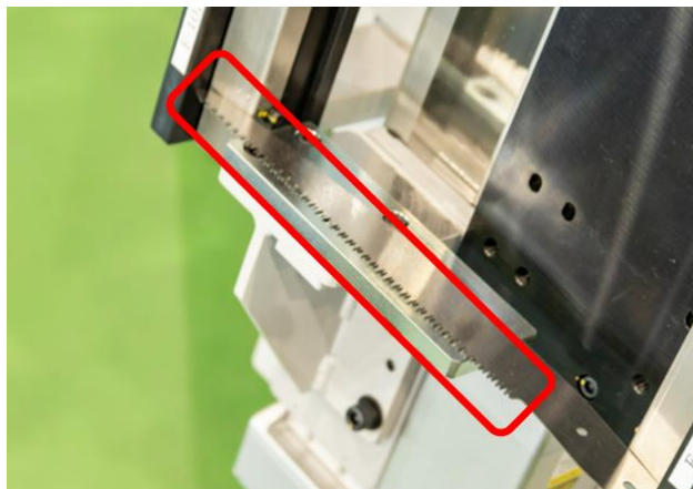
▲鋸の歯の先端を1歯ずつ左右に開く歯振が自動で完成
