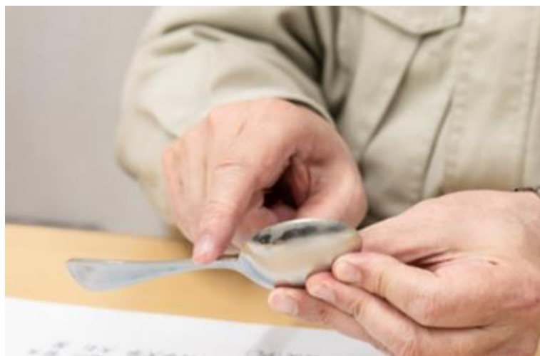
▲打ち抜いたスプーンのフチの研磨を人の手で行うように自動化したい
