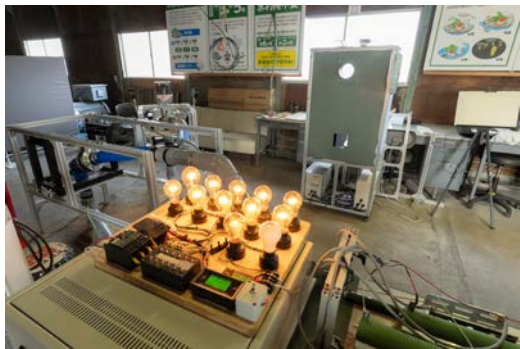
配管の中の水を使って発電する「Crutto」
