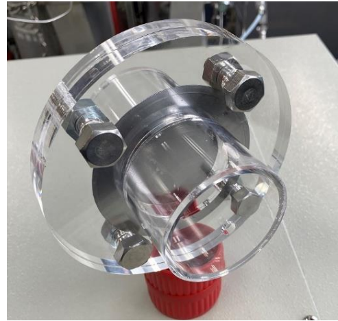
水素精製装置に用いられるバナジウム膜のモックアップ。水素を含む混合ガスのうち、水素のみが当該膜を透過することができる。
