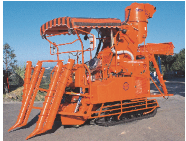
同社のサトウキビ収穫機 「松元式小型ケーンハーベスター」
