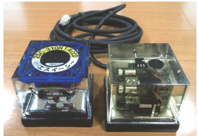
同社の電子回路保護用樹脂「S331」 水漏れを防ぐため電子基板そのものを樹脂に詰めている
