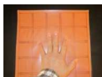
重量・圧力に反応する静電容量重量センサ（圧力分布センサ）
