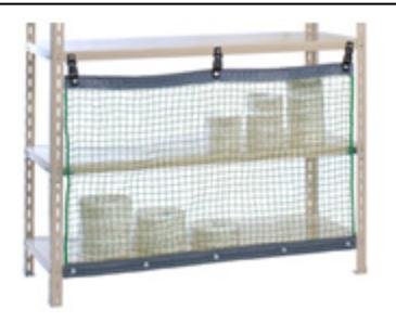
ネットの辺縁部に配設したベルトやワンタッチバックルを棚板に固定する係止具の改良により、棚板の穴開け加工やネジ切り加工が不要となりました。固定したネットで棚上の物が落下するのを防止しつつ、ワンタッチバックルを外すことで簡単に物の出し入れが可能です。
